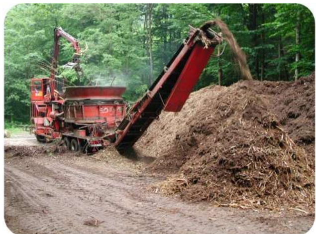
Abb. 7.4-2: Grünabfallhäcksler in einer Kompostierungsanlage
